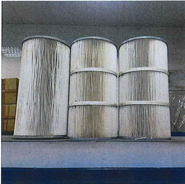
Hình 4.5. Túi vải lọc bụi dự phòng
